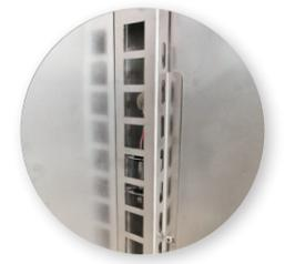
固定传感器位置，防止其与箱体内壁面接触导致监测不准。外加保护罩，有效保证样本与传感器的距离。
